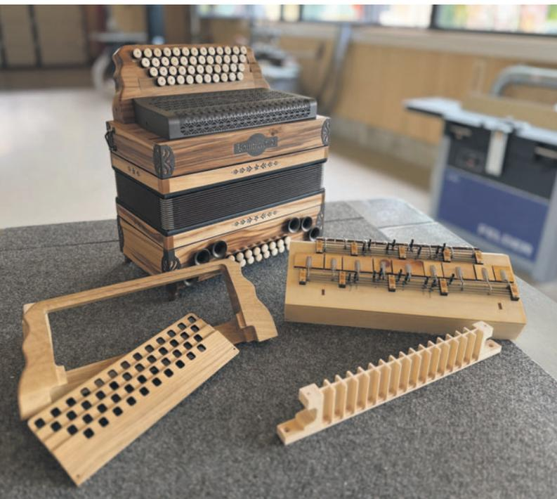
Mit der neuen Fertigungstechnik wird das Holz für eine Harmonika auf hundertstel Millimeter genau bearbeitet.
